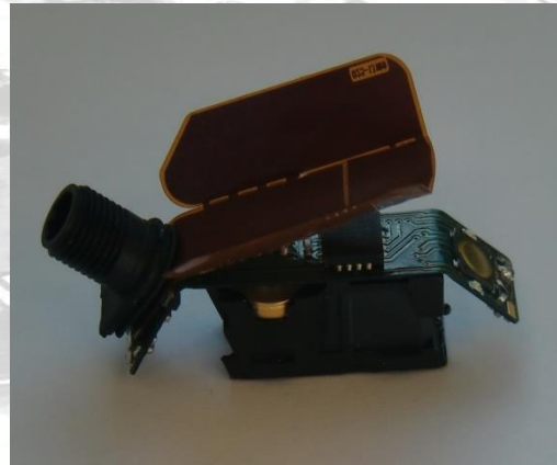
Starr-flexible Leiterplatte als Systemlösung einer 3D-Anwendung
